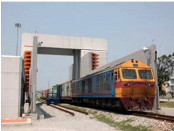
รูปที่ 5 การตรวจสอบ ระบบ X-Ray ตู้สินค้าด้วยอุปกรณ์เครื่องมือ FIX SCAN ณ ท่าเรือแหลมฉบัง ที่มา: สัมมนาศุลกากรแหลมฉบัง 22 กันยายน พ.ศ.2552
