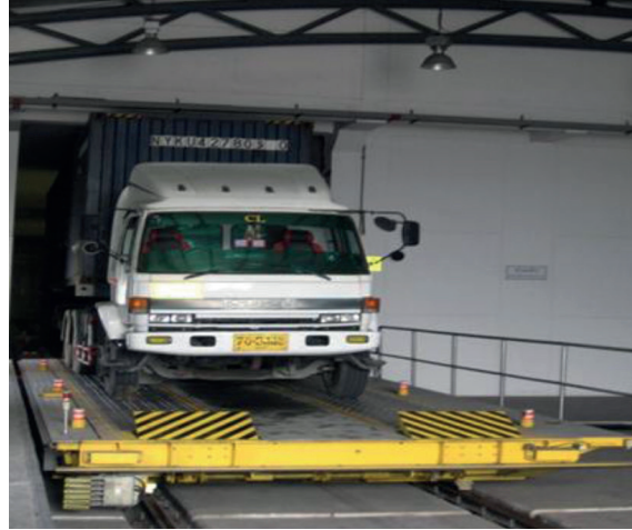
รูปที่ 5 การตรวจสอบ ระบบ X-Ray ตู้สินค้าด้วยอุปกรณ์เครื่องมือ FIX SCAN ณ ท่าเรือแหลมฉบัง ที่มา: สัมมนาศุลกากรแหลมฉบัง 22 กันยายน พ.ศ.2552
