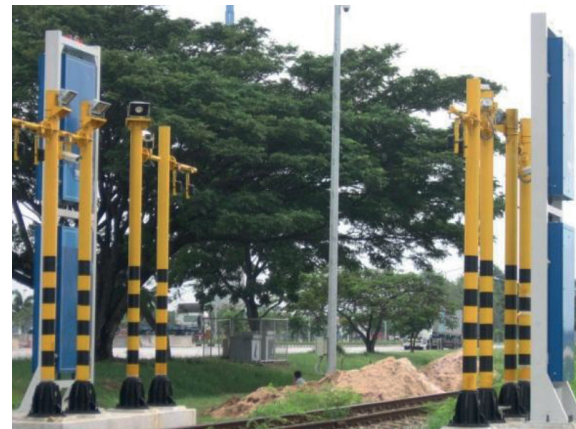
รูปที่ 5 การตรวจสอบ ระบบ X-Ray ตู้สินค้าด้วยอุปกรณ์เครื่องมือ FIX SCAN ณ ท่าเรือแหลมฉบัง ที่มา: สัมมนาศุลกากรแหลมฉบัง 22 กันยายน พ.ศ.2552
