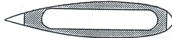
(ข) ถังอับเฉาหลักคลุมโครงสร้างด้านความดันซึ่งเป็นรูปทรงกระบอกอยู่ภายใน
